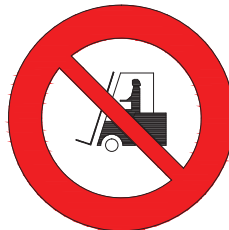
PROHIBIDO EL PASO A CARRETILLAS
