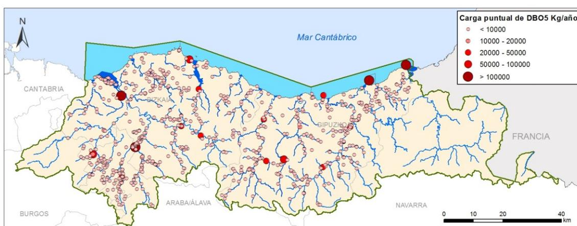
Figura 55. Vertidos urbanos clasificados según carga de vertido de DBO<sub>5</sub> (Kg/año).
