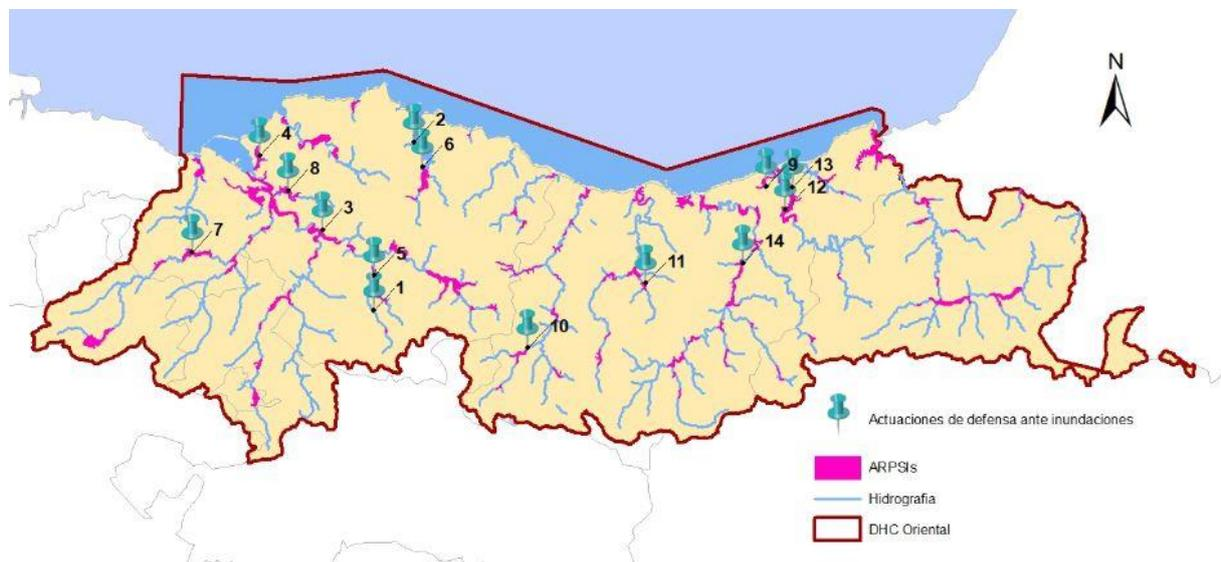
Figura 30. Ubicación de las actuaciones de defensa ante inundaciones realizadas en la parte española de la DHC Oriental. Los números se corresponden con el identificador ID de la Tabla 6.
