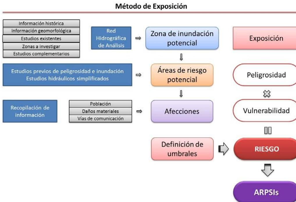
Figura 7. Metodología aplicada en la EPRI del primer ciclo para la identificación de las ARPSIs
