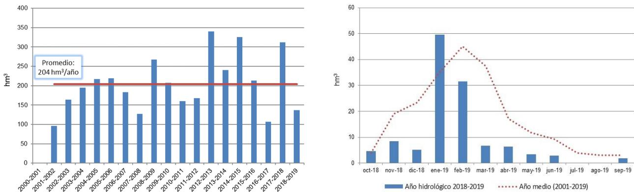
Figura 14 Evolución de la aportación en la estación Sodupe (Fuente: Diputación Foral de Bizkaia)<sup>1</sup>
