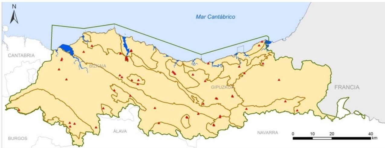
Figura 64 Red de seguimiento del estado de las masas de agua subterránea
