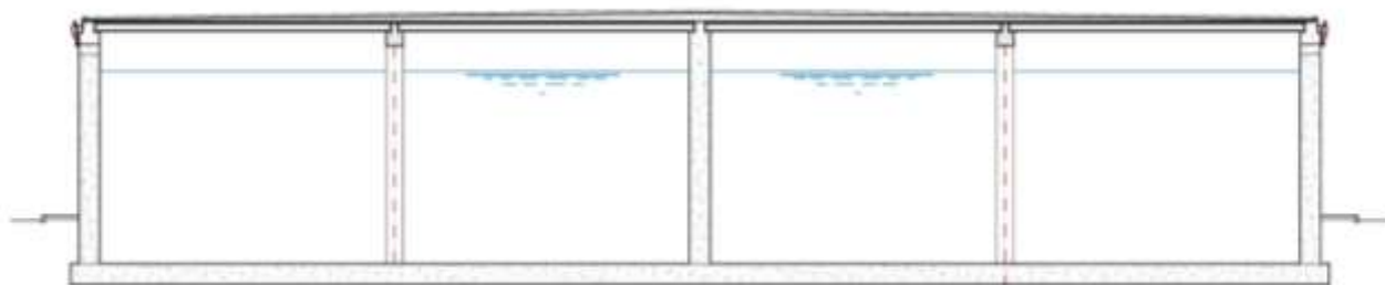
Imagen 8.- Sección transversal del depósito
