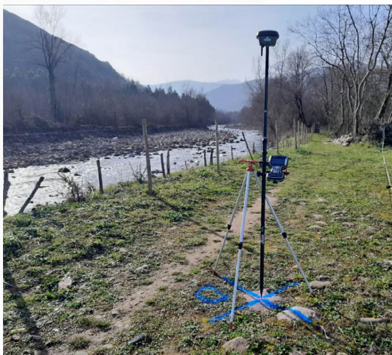
Apoyo vuelo dron con técnicas GPS para la generación de un modelo digital del terreno en el río Saja en Selores, Cabuérniga
