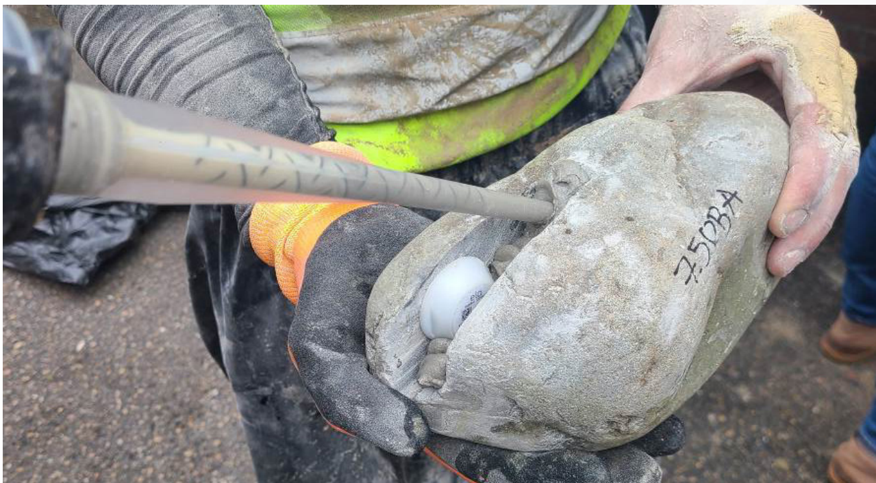
Sellado del hueco con el dispositivo de seguimiento de los arrastres de fondo instalado en el interior de un canto rodado
