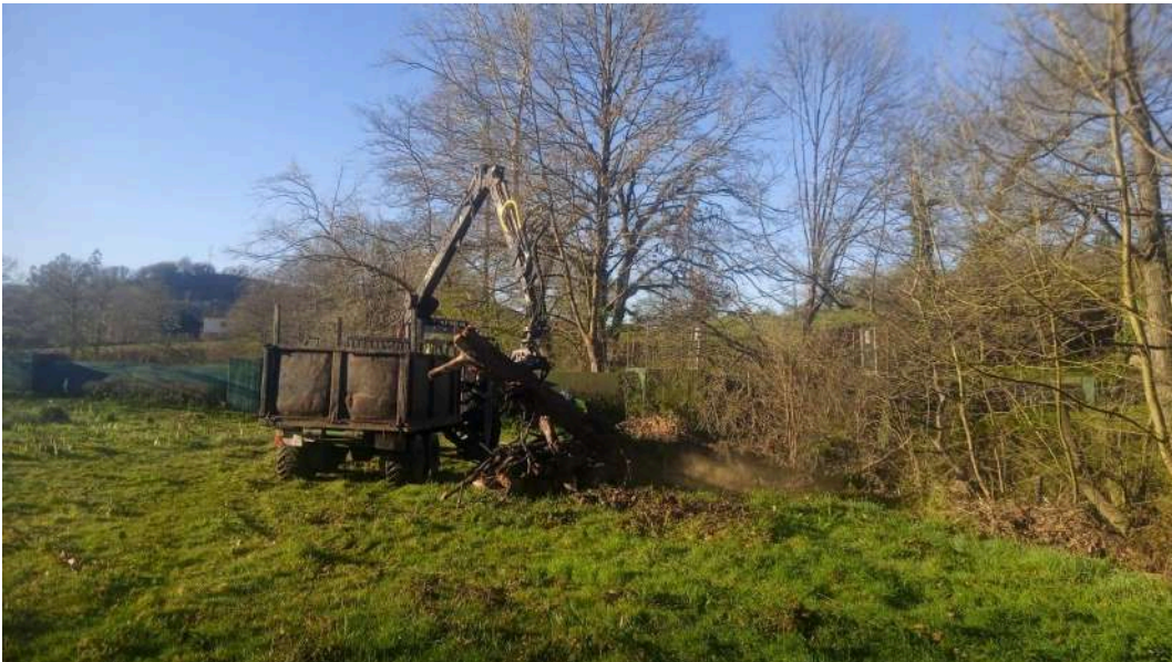
Autocargador retirando restos vegetales
