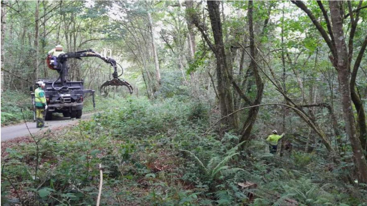
Extracción del cauce de un árbol caído mediante cable y autocargador
