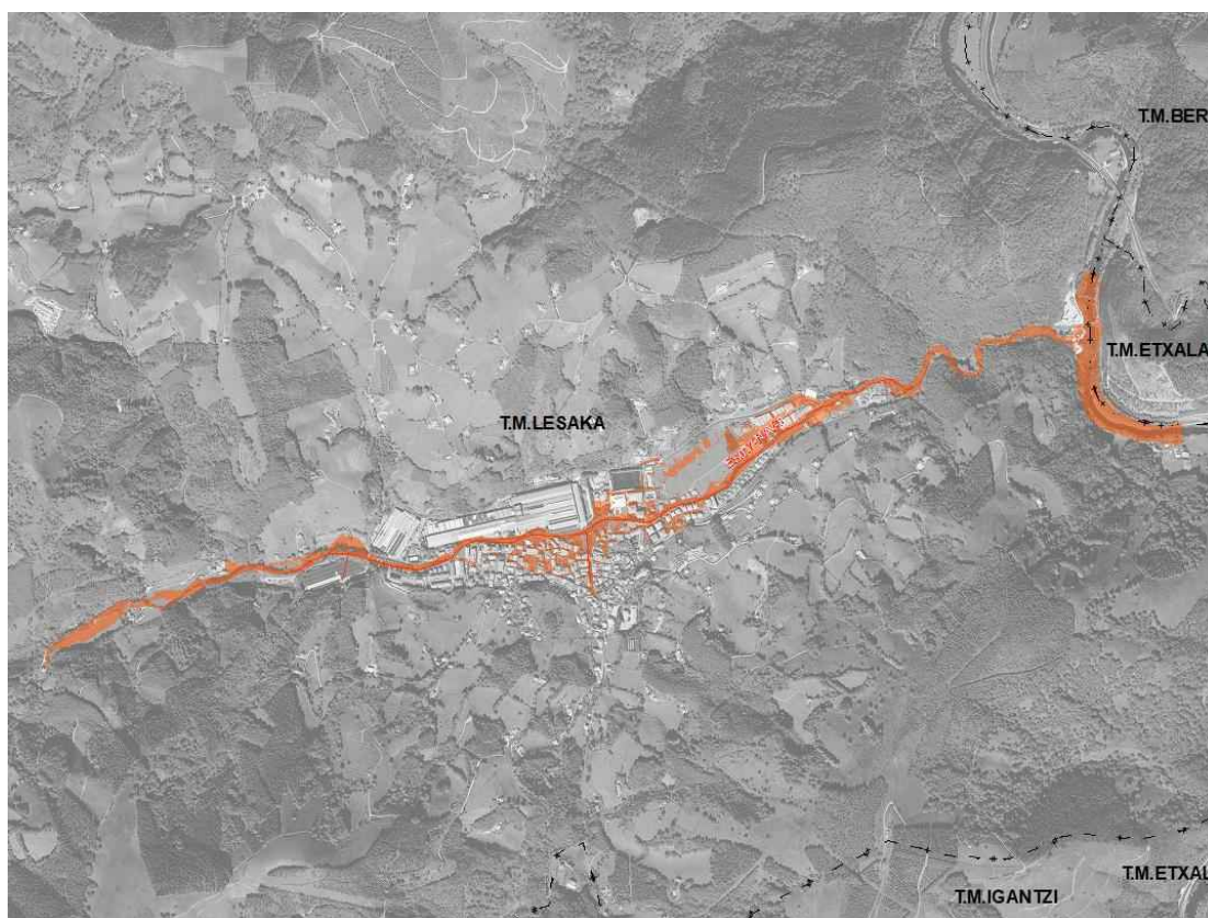
Figura 2: Superficie de alta peligrosidad Lesaka, alternativa 1.
