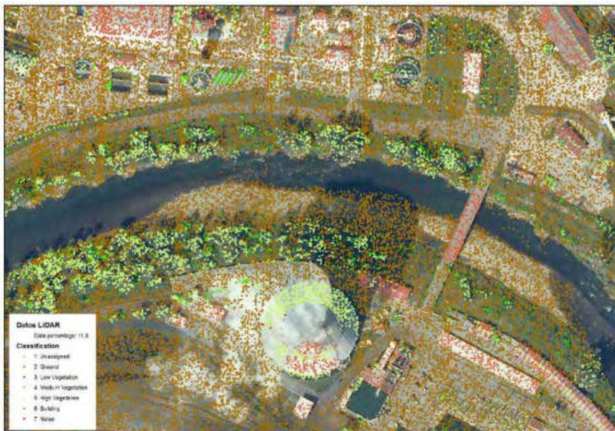
Figura 14. Representación de los puntos de datos LiDAR clasificados por tipo
