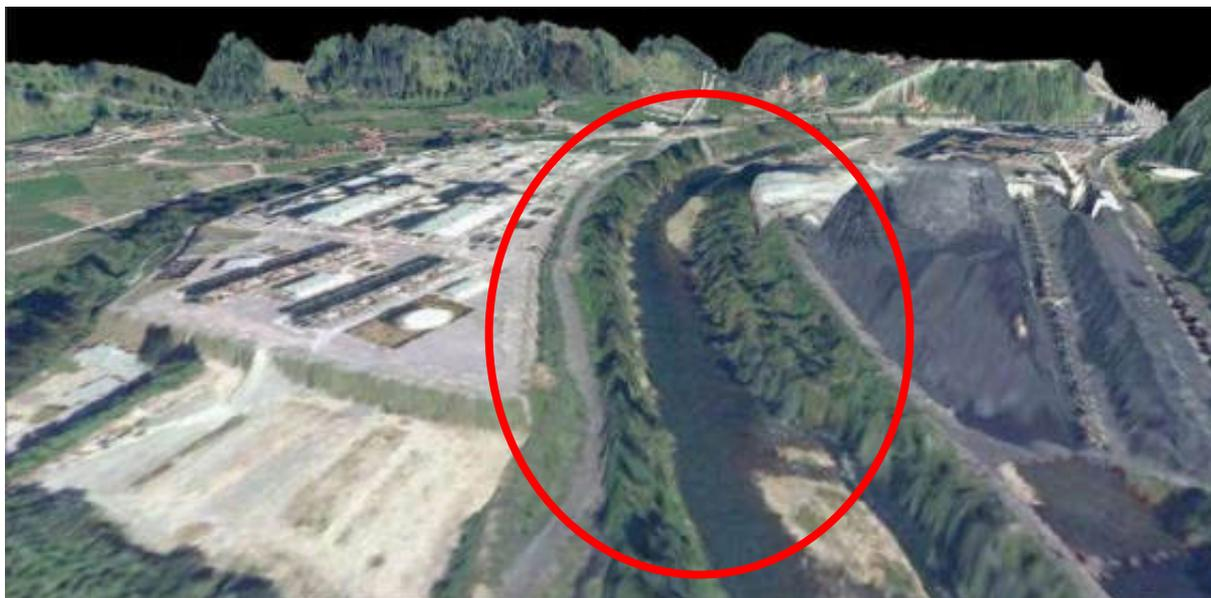
**Figura 12.** *Detalle 3D de los terrenos de la central, vistos desde aguas abajo. Se aprecian la presencia de vegetación en la zona del cauce que ha sido considerada como suelo para la generación del MDT.*
