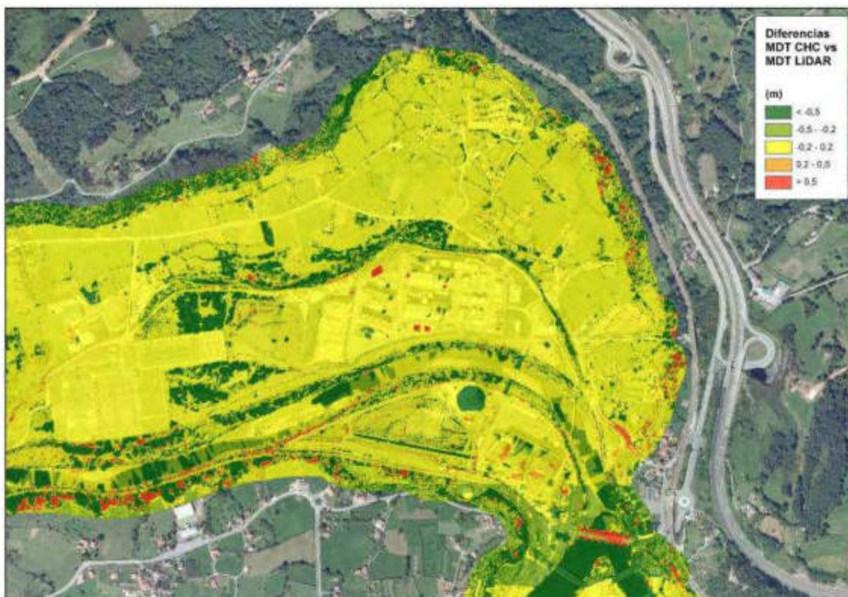
**Figura 10.** Diferencias de cota entre el MDT de la CHC y el MDT confeccionado a partir de los datos LiDAR del IGN, en el entorno de la central.
