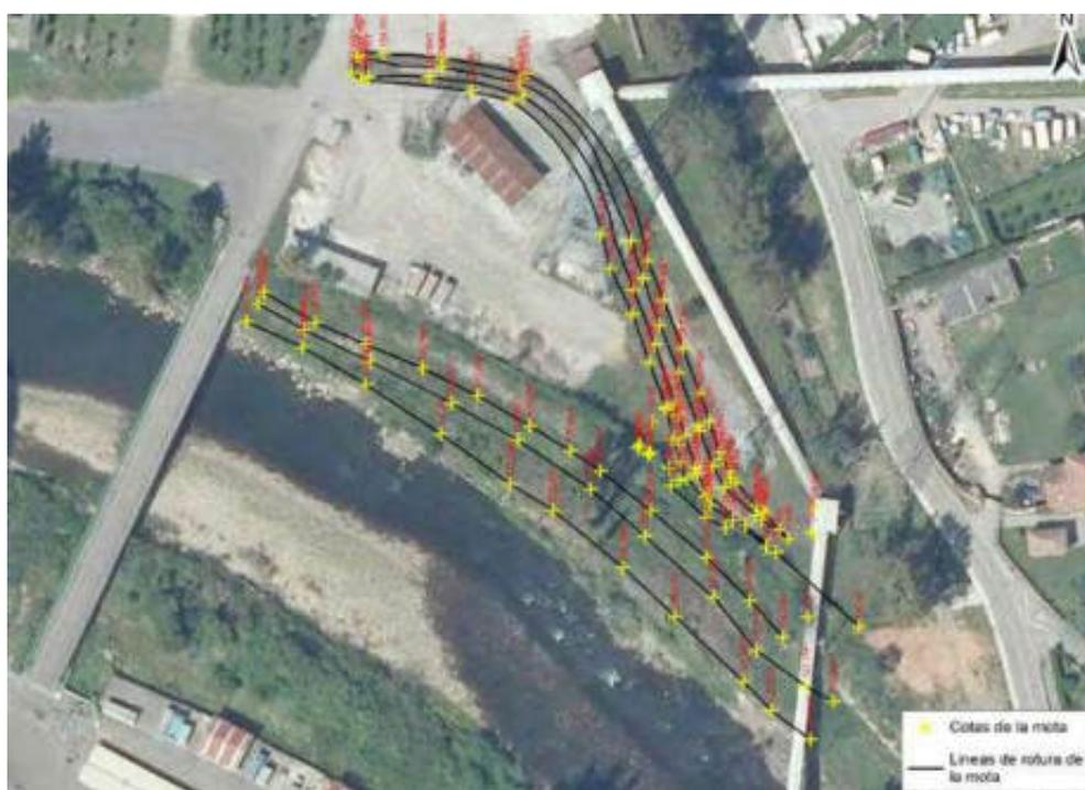
Figura 32. Información topográfica de campo y líneas de rotura asociadas de la mota de protección
