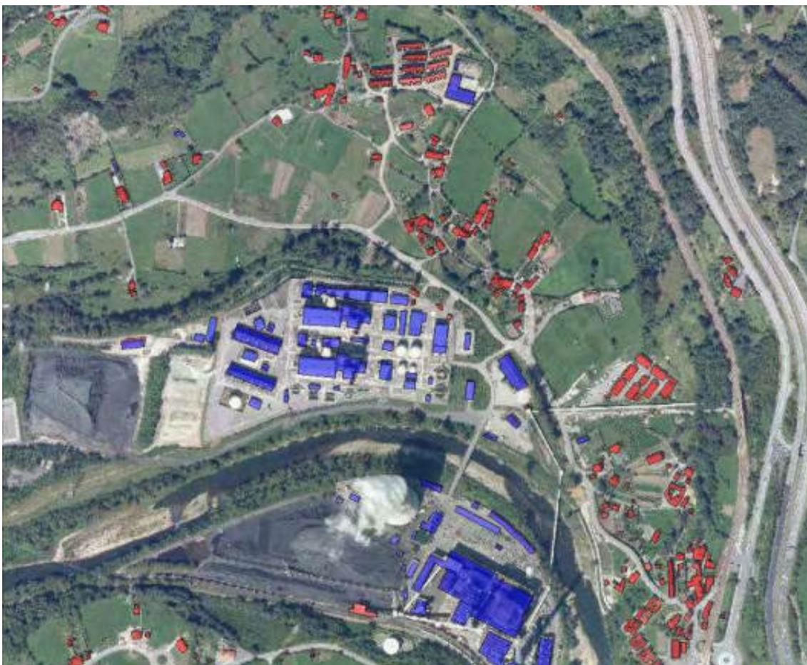
Figura 20. Superposición de edificaciones sobre ortofoto. En rojo: viviendas; en azul: instalaciones industriales
