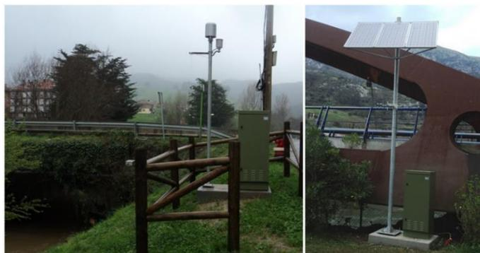
Figura 60.- Estaciones automáticas de bajo coste de la red SAI CHC. Conectada a la red eléctrica (izquierda) y con panel solar (derecha)
