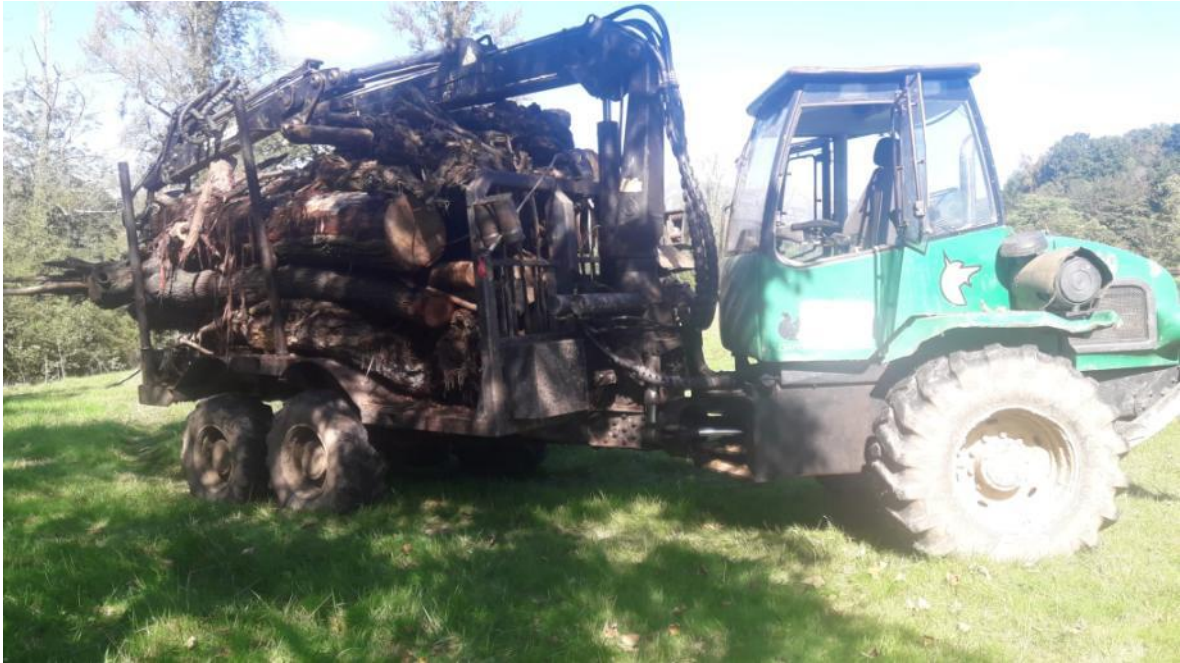
Autocargador trasladando madera retirada del cauce
