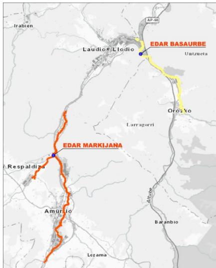
El actual Esquema de Saneamiento del Alto Nervión, plantea la construcción de dos redes colectoras, una para el río Nervión y la otra para su afluente el Altube, que han de conducir las aguas residuales hasta sendas plantas depuradoras, en Markijana y en Basaurbe respectivamente.
