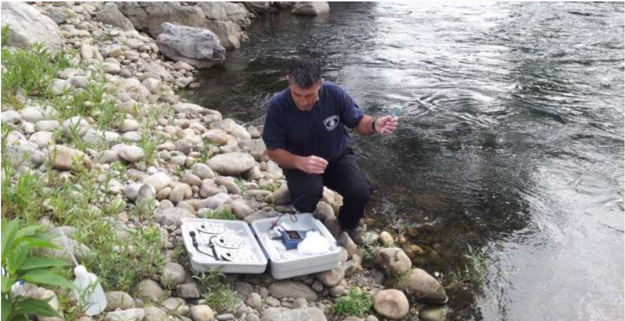
Control de aguas superficiales: medida de parámetros fisicoquímicos in situ
