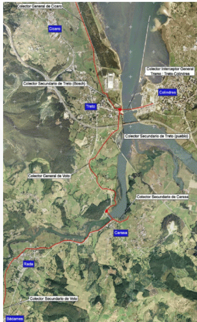
Colector interceptor de la ría de Rada.
