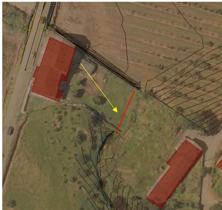
**Figura 12. ODT a reemplazar por cauce a cielo abierto.**
