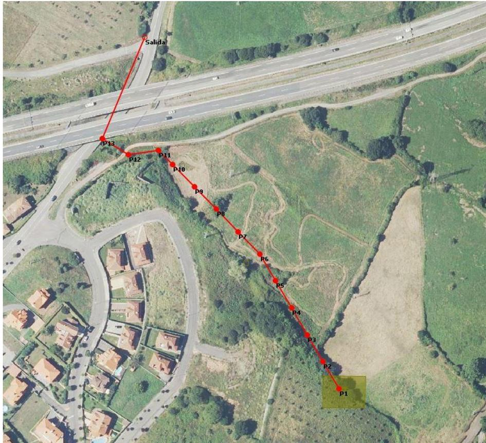
**Figura 9. Trazado del colector propuesto.**
