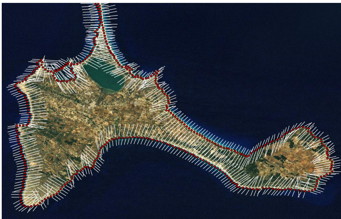
Figura 7. Ejemplo de la segmentación realizada en la isla de Formentera. En rojo, los puntos de la línea de costa cada 200 m. En blanco, perfiles del terreno según la dirección del flujo medio de energía de los temporales.
