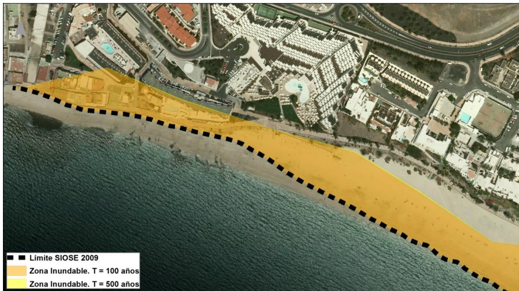
Figura 25. Ejemplo en el que el límite del SIOSE 2009 no alcanza a cubrir toda la zona de playa seca mostrada por la ortofoto (PNOA 2012)
